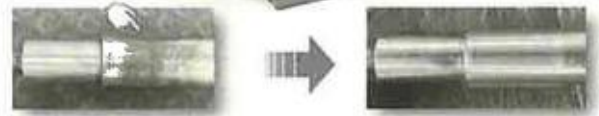
図7 モーターローター軸の摩耗部分を金属溶射し, 加工仕上げした事例
