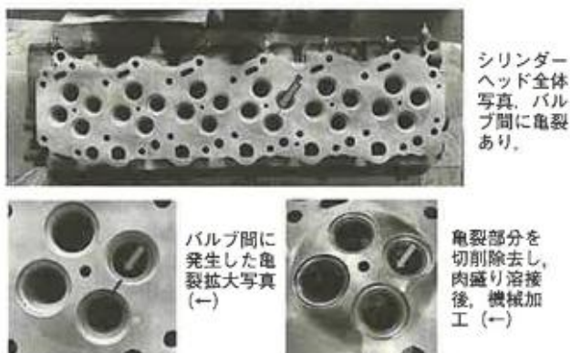
図10 自動車用ディーゼルエンジン(直列6気筒3300cc)のシリンダーヘッドに生じた亀裂補修事例(2C)
