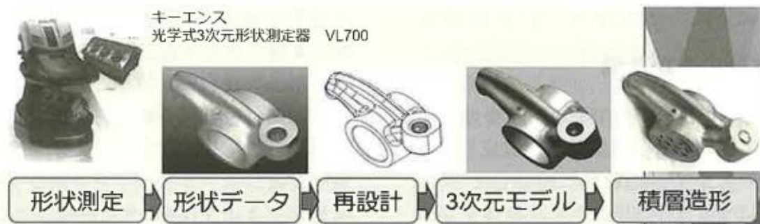
図11 鋳物製ロッカーアームの形状測定,データ取得,再設計,3次元モデル作成,金属積層造形によって部品製造した事例(3C)。この後に機械加工している
