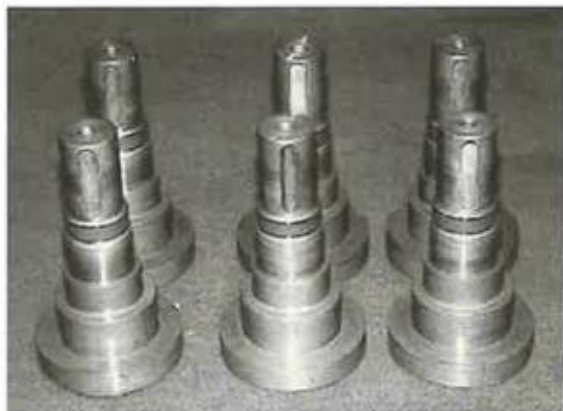
図6 オイルシール部にCr 2 O 3 溶射皮膜
